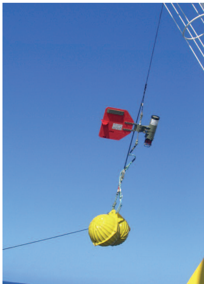
De izquierda a derecha: Roseta oceanográfica con 24 botellas Niskin de 10l.m, CTD y equipada con LADCP utilizada habitualmente en las campañas oceanográficas de variabilidad climática RadProf. Detalle del lanzamiento de un fondeo, correntímetro y boya.
