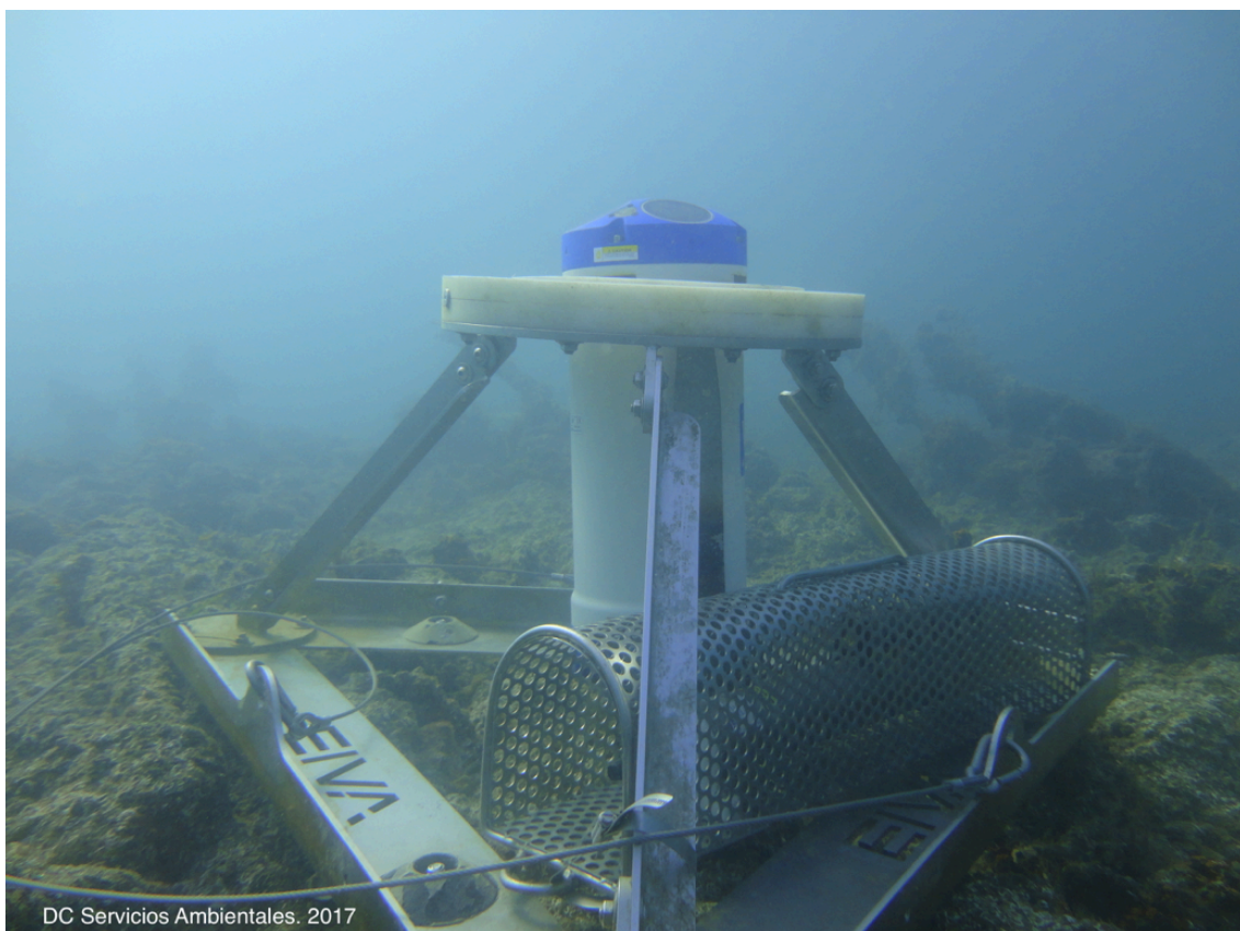
Figura 88.- Anclaje submarino en el canal de El Estacio para la medida de corriente y propiedades termohalinas (ADCP+CTD)
