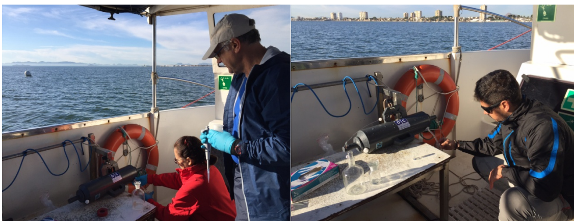
Figura 8.- Muestreo del sistema del dióxido de carbono por el equipo Quima de la ULPGC (izquierda) y muestreo de la concentración de oxígeno por método Winkler por la empresa DC Servicios Ambientales (derecha).
