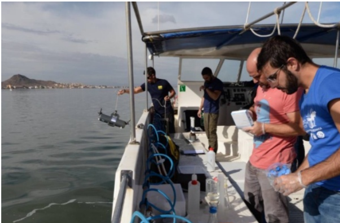
Figura 7.- Uso de la botella niskin horizontal en diferentes puntos de muestreo y profundidad.
