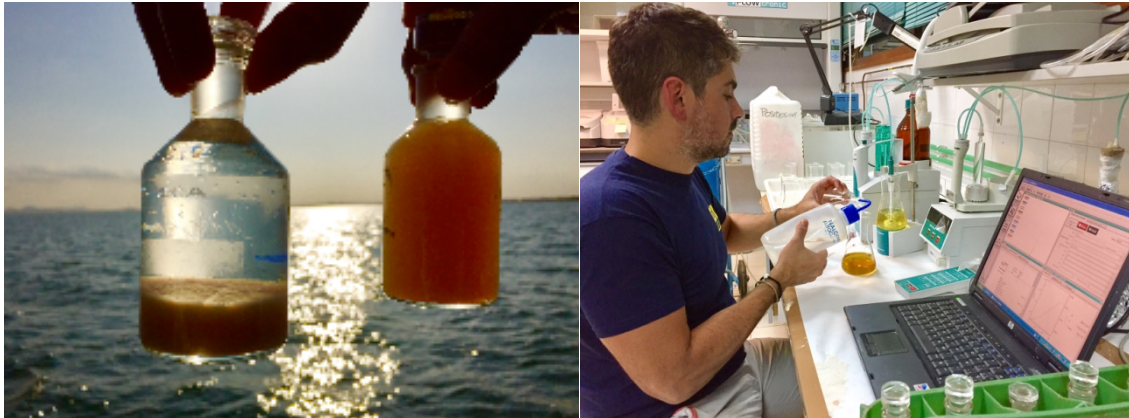
Figura 15.- Recogida de muestras de oxígeno disuelto (izquierda) y valoración de las muestras de la concentración de oxígeno por método Winkler por la empresa DC Servicios Ambientales (derecha).
