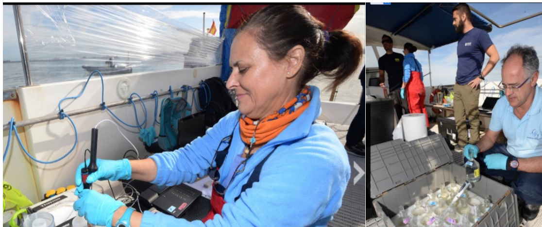
Figura 16.- Muestreo in situ de agua para el análisis de las variables del sistema del dióxido de carbono. Análisis de pH (izquierda) y alcalinidad y carbono inorgánico (derecha). Grupo QUIMA-ULPGC.
