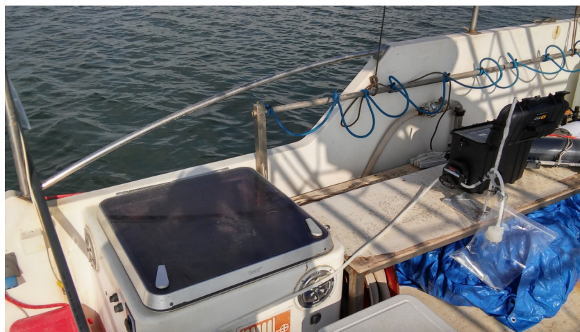
Figura 18.- Sistema de muestreo mediante bomba peristáltica y filtro de cartucho para recogida de agua con el fin de medir metales disueltos en aguas del Mar Menor.
