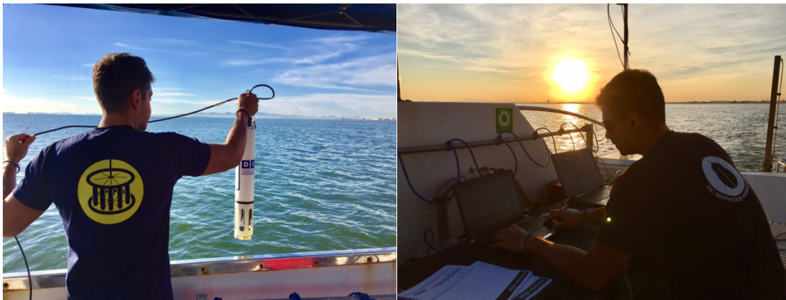
Figura 6.- Sonda multiparamétrica para la adquisición de medidas físico-químicas en las estaciones hidrográficas (izquierda). Punto de adquisición y pre-procesado de datos de CTD (derecha).
