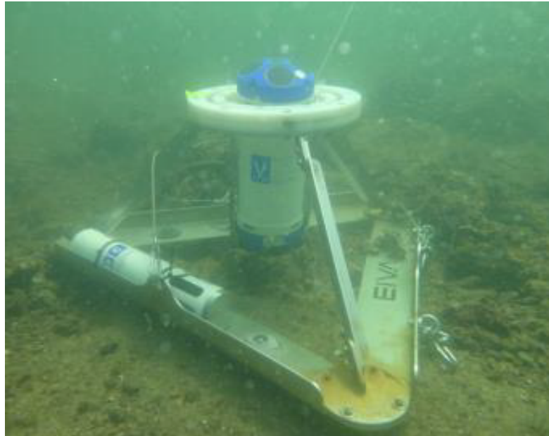
Figura 14.- Sistema ADCP + CTD anclado en el canal de El Estacio durante las campañas oceanográficas (MM0217, MM0617 y MM0917).
