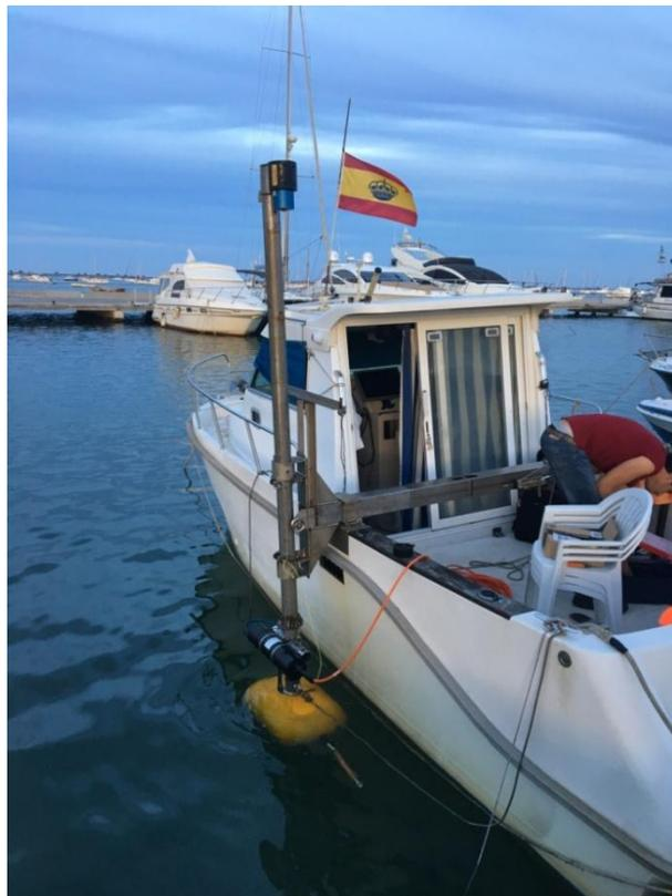
Figura 14.- Embarcación Prosermar Sexto con Geopulse instalado
