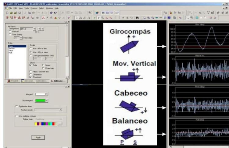
Figura 21: Corrección de los Sensores (navegación, ola, cabeceo o balanceo)
