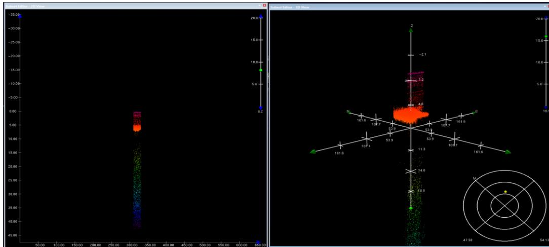
Figura 25a: Ventanas de visualización de las sondas (2D a la izquierda y 3D a la derecha) para su selección o rechazo en el modo Subset previo a la edición de datos.
